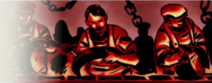
El sistema de Ford de **producción en serie** estaba basado en la cadena de montaje. Los obreros se situaban junto a una cinta transportadora que iba acercándoles las piezas y cada uno se ocupaba de una parte muy especializada del proceso. Una vez que su trabajo estaba terminado, la cinta se movía hacia el próximo obrero. Al final de la cadena, el automóvil estaba terminado y listo para funcionar.
